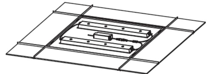
C: Fixez le filin de sécurité et installez le luminaire dans le plafond.
