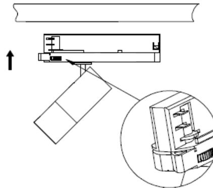
2. Placer l'adaptateur dans le rail et l'accrocher. Choisissez L2/L2/L3 sur le bouton en fonction de votre circuit.
