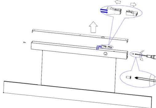
2 Installer le couvercle au plafond et insérer le câble dans la prise mâle
