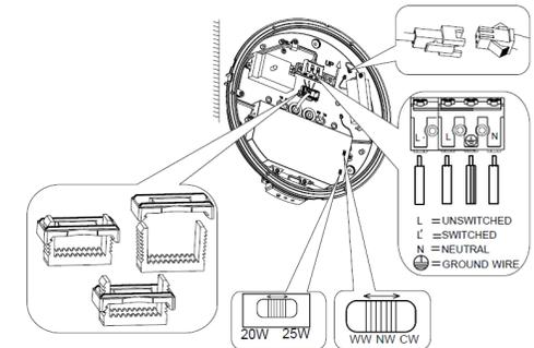
**5** Connecter les fiches DC, remettre le couvercle sur la plaque arrière et le fixer avec des vis.
