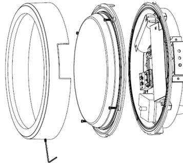
**3** Fixez le boîtier arrière sur le mur ou au plafond à l'aide de vis.
