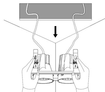
3. Insérer le driver et le downlight dans le trou en pinçant les ressorts
