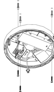
**4** Connectez le fil CA dans le bornier : Si avec 3CCT, choisissez la CCT
