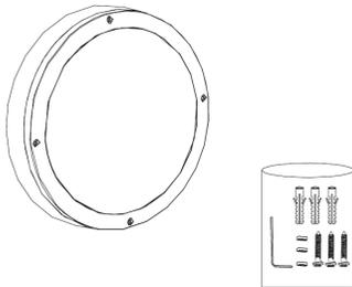
**2** Pour les formes rondes uniquement : dévissez le cadre avant, démontez le couvercle de la lampe en le faisant tourner dans le sens antihoraire. Pour les formes carrées et ovales, dévissez le cadre avant et retirez-le.
