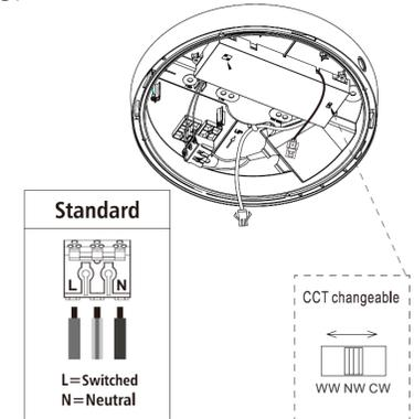
**5** Branchez le connecteur mâle et le connecteur femelle. Alignez les crochets du couvercle de la lampe avec l'encoche de la base, tournez le couvercle de la lampe dans le sens horaire jusqu'à ce qu'ils correspondent bien. Pas besoin de faire pivoter le cadre de forme carrée ou ovale, clipsez directement le couvercle de la lampe.
