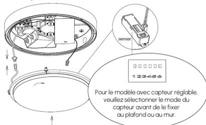
**6** Clipsez le cadre dans la base, tournez le cadre dans le sens horaire jusqu'à ce qu'ils correspondent bien, fixez le cadre avec la vis. (Lampe de forme carrée et ovale sans fermeture rotative, tenir le couvercle et le fixer avec des vis)
