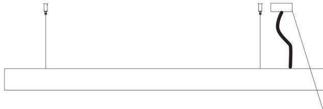
C : fixer l'attache du filin de suspension au plafond et vissez le réglage au travers.
