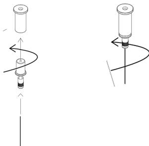
**Nota :** La fixation des filins de suspension est comprises entre 1cm et 10cm a chaque extrémité du luminaire , sur l'ensemble des modèles .
