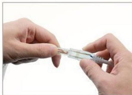
Insérer le « pin » dans le « strip » et connecter fermement les deux parties
