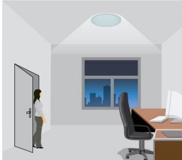
En cas de lumière naturelle insuffisante, le capteur allume automatiquement la lumière lorsqu'une présence est détectée.
