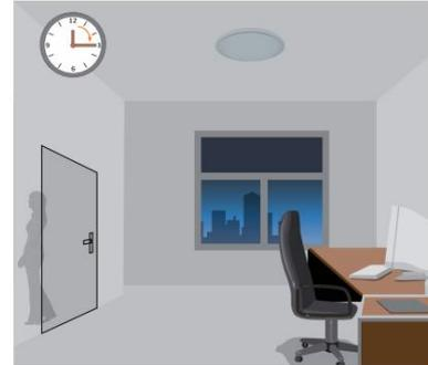
Le capteur éteint automatiquement la lumière après le temps de maintien lorsqu'aucun mouvement n'est détecté.
